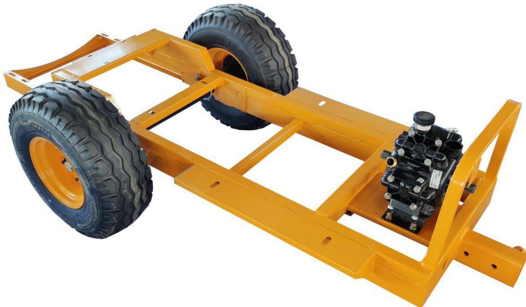
牵引式果园风送喷雾机结构底盘和匹配的超宽低压真空轮胎.
